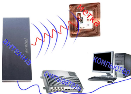
Рис. 5. Принцип работы RFID-системы
