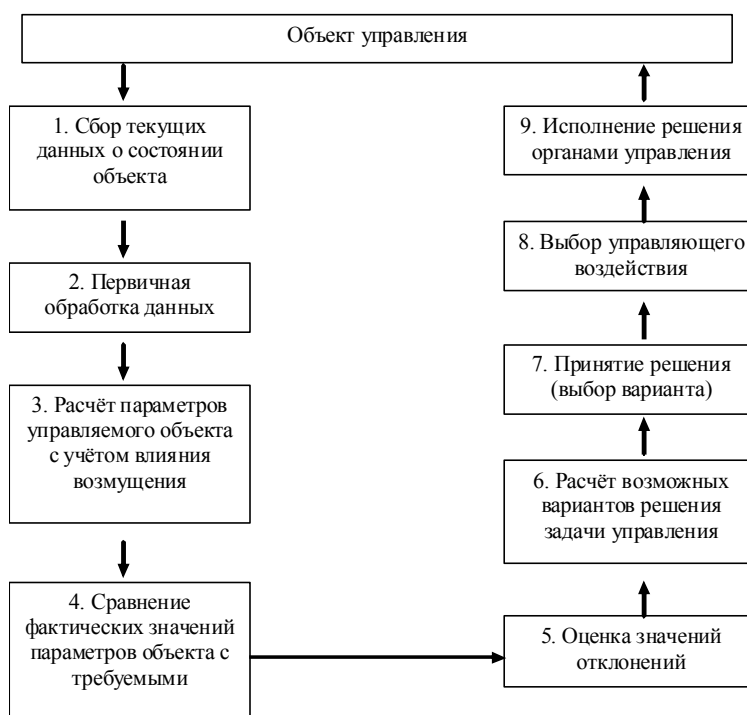
Рис. 1. Упрощенная схема переработки информации в АСУ ТП
