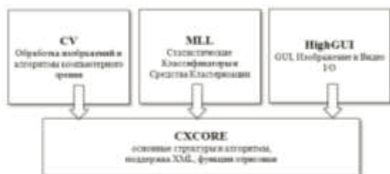
Рис. 2. Базовая структура OpenCV
