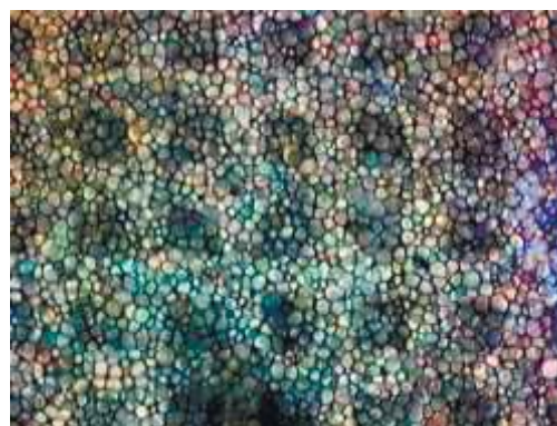
Рис. 3. Микрофотография электронной бумаги: Pearl устройства Sony PRS-650 с воспроизведенным на ней полем яркостью 128 относительных единиц
