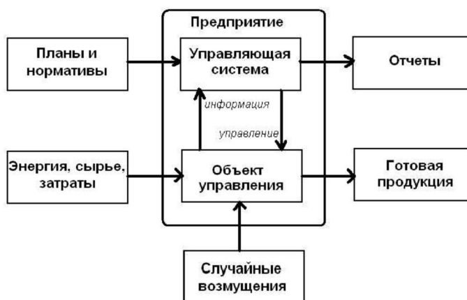
Рис. 1. Структурная схема моделирования производственного предприятия
